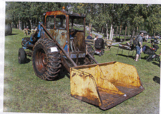
Lasteraggregatet har kraftige rammebjelker som fester for armer og sylindere. Skuffa er parallellført.
